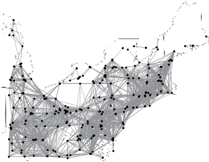
FIGURE 1. INTERFERENCE CONSTRAINTS BETWEEN BROADCAST TOWERS
